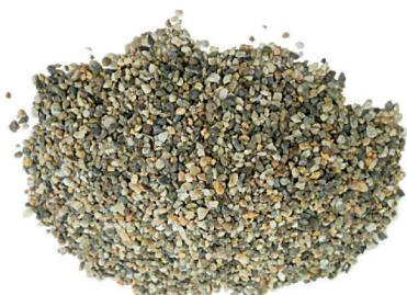
● Le sabbie ed i ghiaini umidi per filtrazioni sono aggregati naturali lavati e calibrati, esenti da impurità organiche, agenti inquinanti e con un contenuto di silice medio alto. Ideali per la realizzazione di filtri e per il trattamento e la depurazione dell'acqua.
